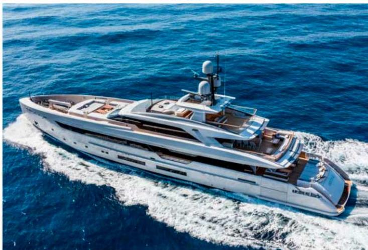
Autre atout, le Tankoa S501 M/Y Vertige est un navire extrêmement stable. Cela c'est confirmé lors des essais en mer, même lorsque les stabilisateurs n'étaient pas activés. La propulsion est assurée par deux moteurs MTU développant 746 kW chacun, permettant une vitesse de croisière de 14 nœuds, pour une vitesse maximale de 16 nœuds.
